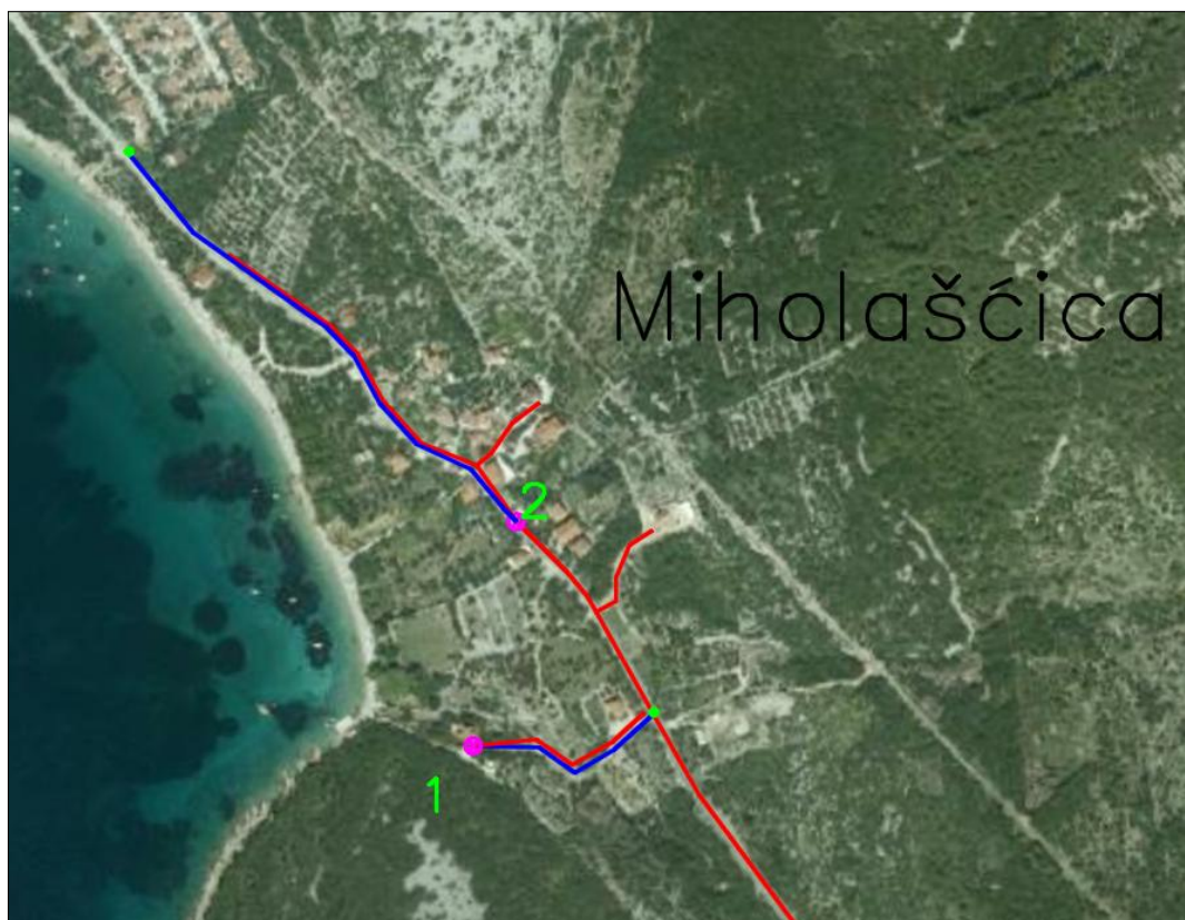
Slika 2.4-1. Shema varijantnog rješenja sustava odvodnje naselja Miholašćica
